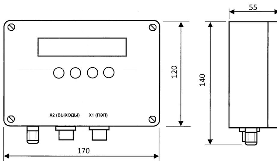
Рисунок 2.3. Габаритный размер электронного блока исполнения «без архива»
