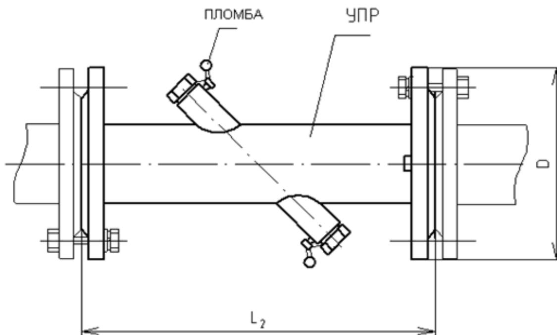
Рисунок 2.5. Габаритные и установочные размеры прямого исполнения УПР.
