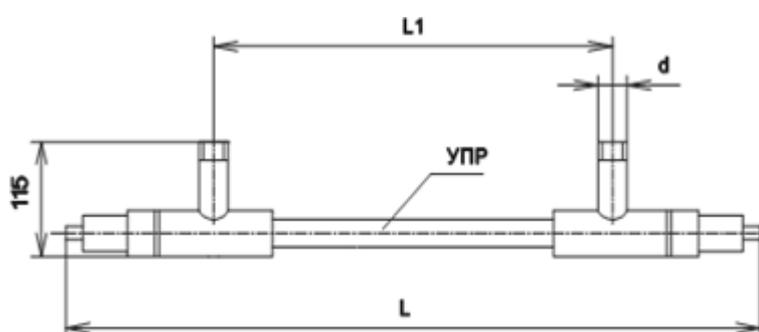
Рисунок 2.4. Габаритные и установочные размеры П-образного исполнения УПР.
