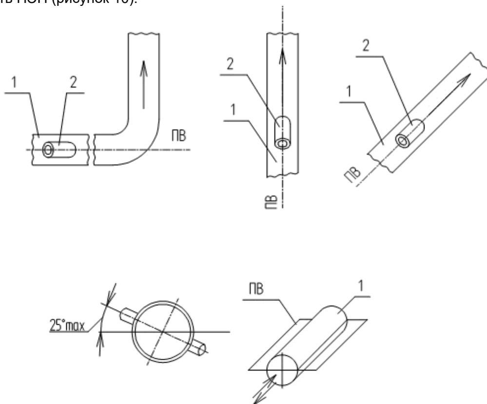
Монтаж УПР П-образной конструкции осуществлять в горизонтальной плоскости, т.е. акустическая ось должна располагаться не выше оси трубопровода и не ниже 25 градусов этой оси
